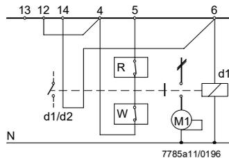
Erforderliche Verdrahtung für den Betrieb ohne Luftdrucküberwachung
