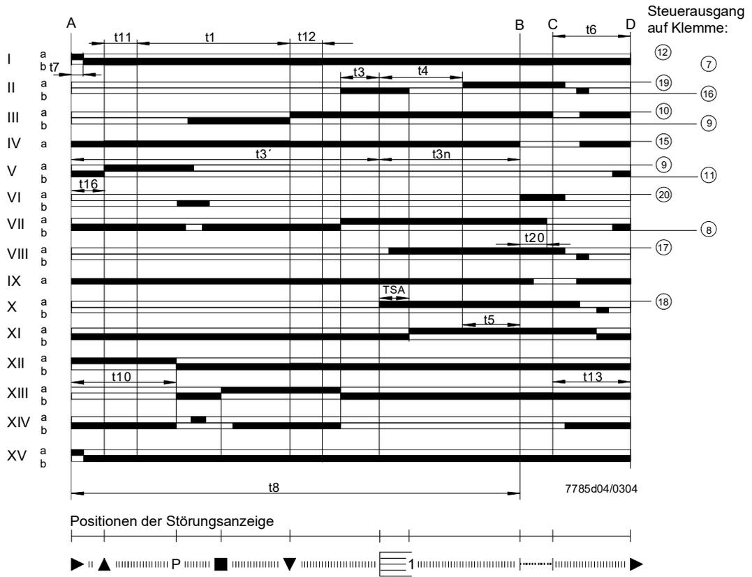
Einrohrbrenner (Brenner ohne Zündbrenner), gesteuert und überwacht mit **LOK16** oder **LGK16**. Luftklappe während der Betriebspausen in Kleinflammenstellung (min.).
