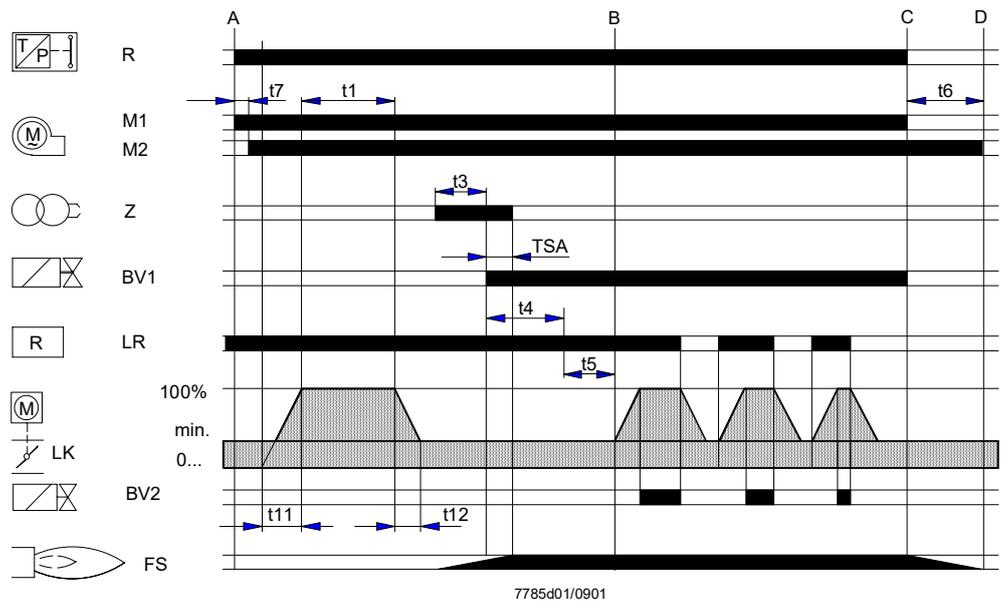
2-Rohrbrenner (Brenner mit Zündbrenner), gesteuert und überwacht – als Beispiel – mit **LGK16.335** oder **LGK16.635**. Die übrigen Automaten vom **LGK16** programmieren für den Zündbrenner die Zeiten Sicherheitszeit (TSA), Vorzündzeit (t3), Intervall (t4) und zweite Sicherheitszeit (t9).
