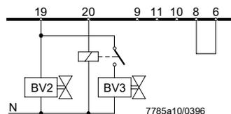
Steuerung eines Brennstoffventils von Klemme 20 bei Brenner ohne Luftklappe bzw. mit nicht vom Automaten gesteuerter Klappe
