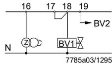
Verdoppelung der Sicherheitszeit bei Einrohrbrennern bei Verwendung der Automaten **LGK16.335** und **LGK16.635**.
