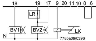
Steuerung des Stellantriebs während des Betriebs durch Steuersignale auf Klemme 17
