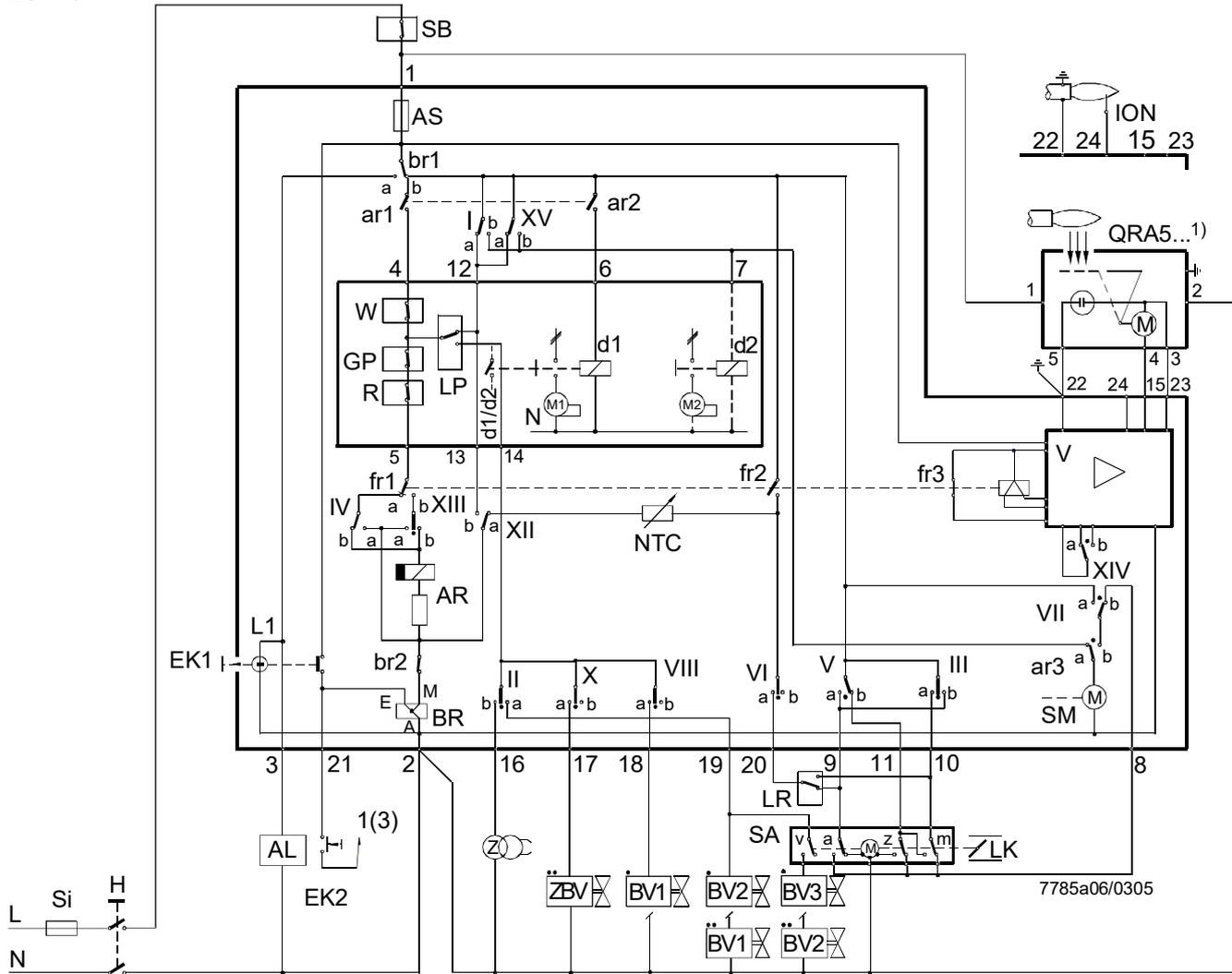
1) In Verbindung mit QRA53/QRA55 ist Klemme 22 unbedingt an Erde zu legen!
