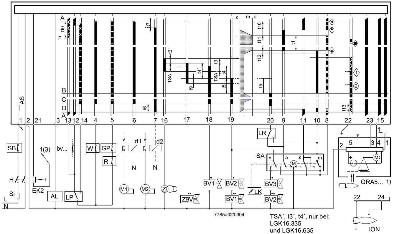
1) In Verbindung mit QRA53/QRA55 ist Klemme 22 unbedingt an Erde zu legen!
